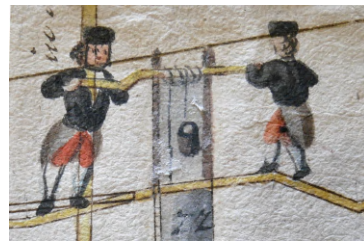
Fürstenbergische Bergleute fördern Eimer mit Erz mit einer Haspel, um 1750.
